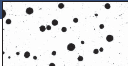
该显微照片显示了100倍下典型的微孔外观
